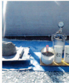
生コン性状確認試験 (スランプ管理)
