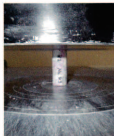
小径コアの圧縮試験 (直径20mm程度)
