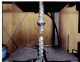
鉄筋継手部の引張試験
