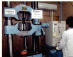
DBヘッド定着工法引張試験
