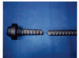
DBヘッド定着工法試験体の破断位置確認
